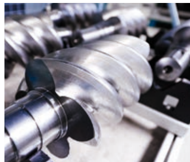
Bei höheren Drücken überlegen: Rotorprofile von Schraubenverdichtern
